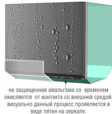
ПРИМЕР КОРРОЗИИ АМАЛЬГАМЫ
