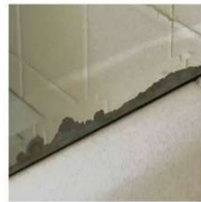
ПРИМЕР КОРРОЗИИ АМАЛЬГАМЫ
